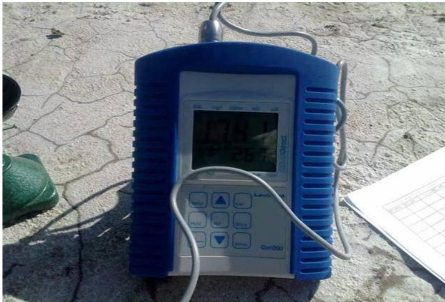
شکل ۶- تصویری از دستگاه EC متر صحرائی که برای قرائت شوری در صحرا مورد استفاده واقع شده
