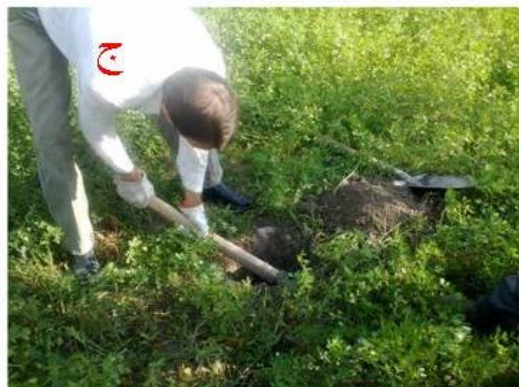
شکل ۲- نمونه برداری نقاط از دو عمق ۰-۲۰ (ب و د) و ۲۰-۴۰ سانتی متری (الف و ج).
