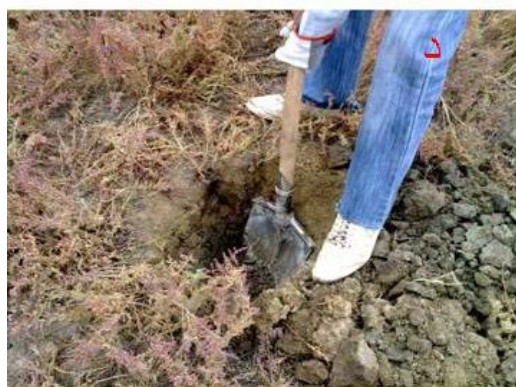
شکل ۲- نمونه برداری نقاط از دو عمق ۰-۲۰ (ب و د) و ۲۰-۴۰ سانتی متری (الف و ج).
