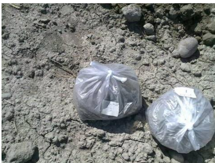
شکل ۳- نمونه های مربوط به یکی از نقاط که از دو عمق مختلف گرفته شده و به طور جداگانه بسته بندی شده اند.
