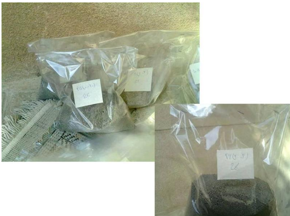
شکل ۸- بسته بندی نمونه ها در کیسه های سلفن و شماره گذاری آنها
