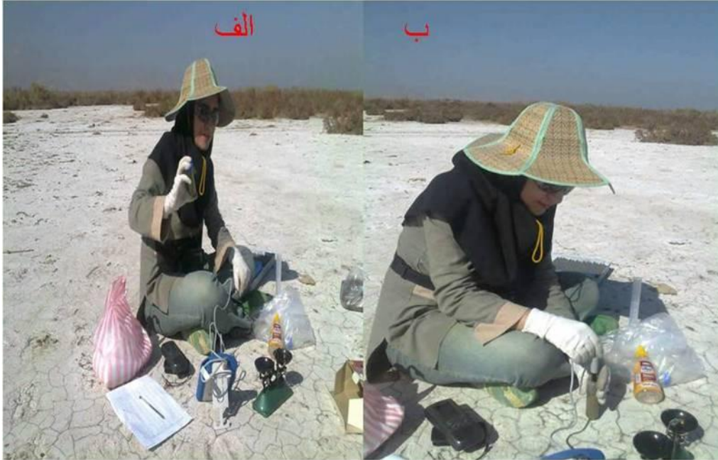
شکل ۵- شیک نمونه ها در لوله های سانترفیوژ ۵۰ سی سی (الف) و قرائت EC نمونه ها با EC متر
