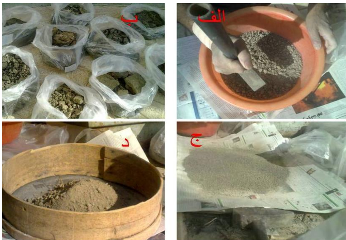
شکل ۷- مراحل آماده سازی نمونه ها برای انتقال به آزمایشگاه. الف: کوبش نمونه ها، ب: خشک کردن
